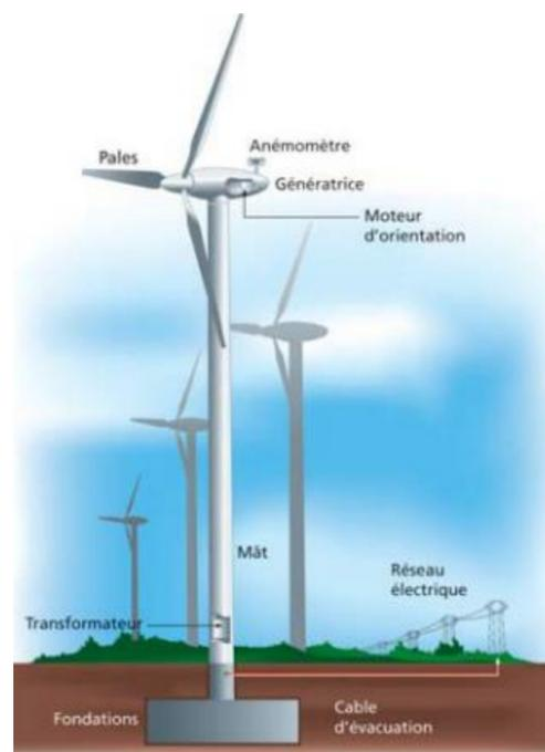
Figure 7 : Représentation schématique d'une éolienne (Source : EDF)
